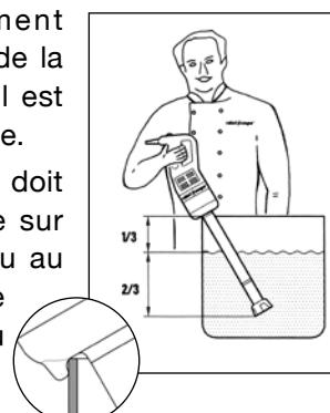
Dans le cas où le mixer est utilisé avec son support marmite, vérifier que le mixer se trouve au centre du récipient, qu'il est légèrement incliné et que la cloche ne touche pas le fond de la marmite.
