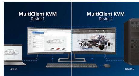
Grâce au commutateur KVM multclient intégré, vous pouvez contrôler deux PC distincts avec un seul système moniteur-clavier-souris (KVM). Un bouton commode vous permet de basculer rapidement entre les sources. Pratique pour les installations nécessitant la puissance de calcul de deux PC ou lorsque vous souhaitez utiliser un seul grand moniteur pour afficher le contenu de deux PC différents.
