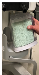
Εικόνα 1 Τοποθέτηση του SmartCan στον δίσκο ανύψωσης
