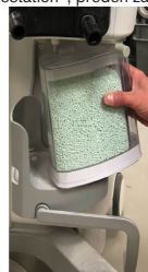
Slika 1: Postavitve pripomočka SmartCan na dvigni krožnik
