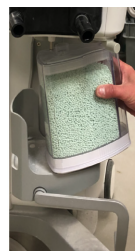
Figur 1 Isætning af SmartCan i løfteskål
