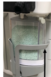
2. ábra A kar felemelése és a SmartCan helybe rögzítése
