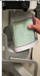
Figura 1 Colocar o SmartCan no prato elevatório
