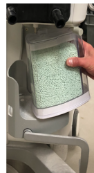
Slika 1 Ubacivanje apsorbera SmartCan na platformu
