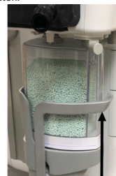
Figur 2 Heve håndtaket og låser SmartCan på plass posisjonen vassetsten.
