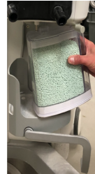
Şekil 1 SmartCan'ı kaldırıcı tabana yerleştirme
