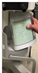
Фигура 1 Поставяне на SmartCan на повдигащата тарелка
