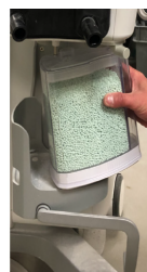
Figura 1 Plasarea SmartCan pe platforma de ridicare
