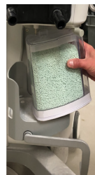
Slika 1 Postavljanje apsorbera SmartCan na podizno postolje
