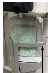
図2 ハンドルを上あげてSmartCanを所定の位置に固定する
