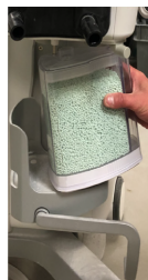
図1 リフターディッシュにSmartCanを載せる
