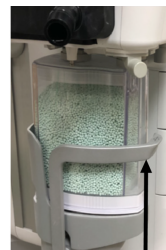
Joonis 2 Käepide tõstmine ja absorberi SmartCan oma kohale lukustamine
