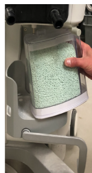
Рисунок 1. Установка SmartCan на подъемной тарелке
