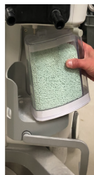
圖 1 將 SmartCan 放到升降盤上
