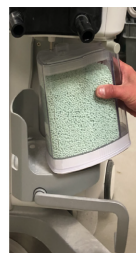
Ilustracja 1 Umieszczanie pochłaniacza SmartCan na platformie podnośnika
