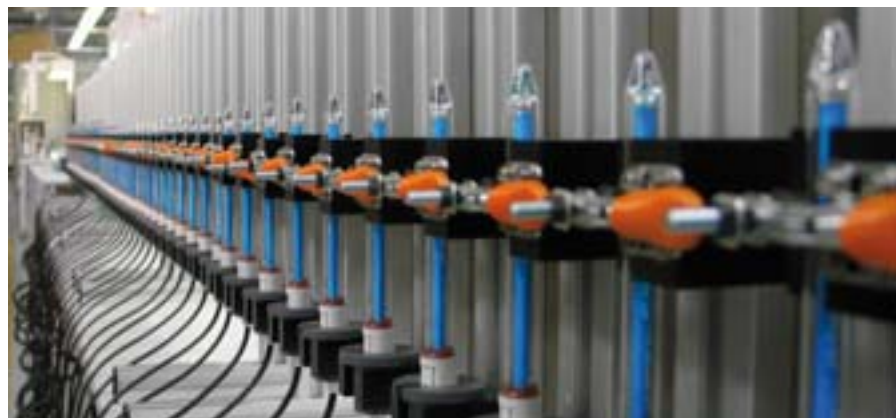
Contrôle de qualité soigneux. Le point zéro, la pente et la stabilisation de chaque électrode sont contrôlés, comme ici pour un lot de BlueLine.
