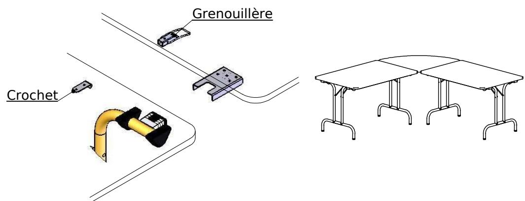
2 - Verrouiller les plateaux entre-eux à l'aide des grenouillères et crochets fixés sous les plateaux.
