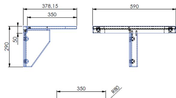
Dimensions : Longueur 590mm hauteur 290mm profondeur 390mm
