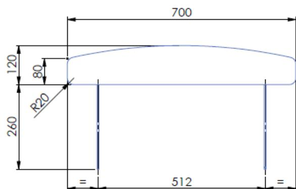
Les signalisations sont en tôle épaisseur 2mm finition époxy.
