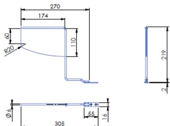
Les signalisations sont en tôle épaisseur 2mm finition époxy.
