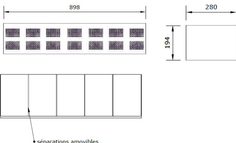
Dimensions : Longueur 898mm hauteur 194mm à l'arrière profondeur 280mm
