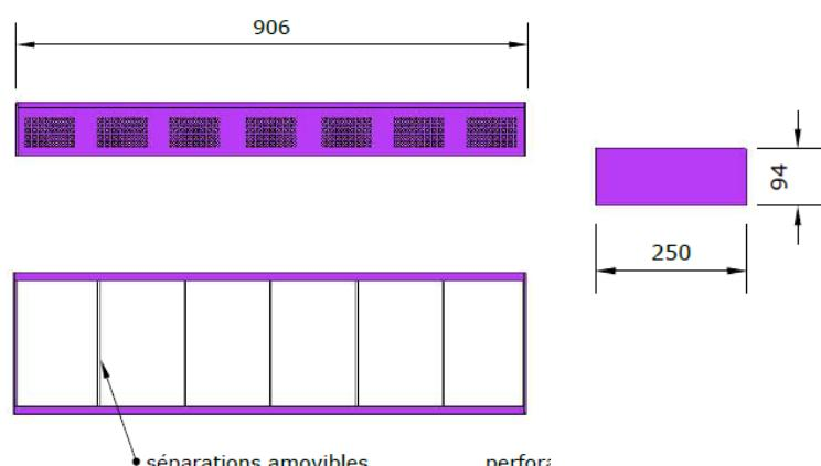
Dimensions : Longueur 898mm hauteur 94mm à l'arrière profondeur 250mm
