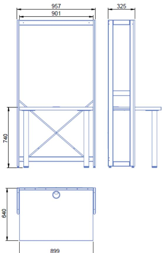
Le plateau est fabriqué en panneau de particules surfacé mélaminé épaisseur 38mm. Les chants en contact direct avec les utilisateurs sont en ABS 2mm.
