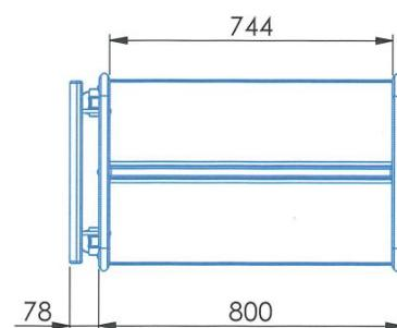
Dimensions : Longueur 878mm hauteur 966mm profondeur 520mm
