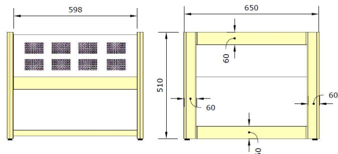
Dimensions : Longueur 656mm hauteur 510mm profondeur 650mm
