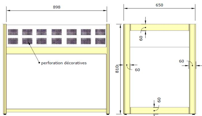
Dimensions : Longueur 956mm hauteur 810mm profondeur 650mm
