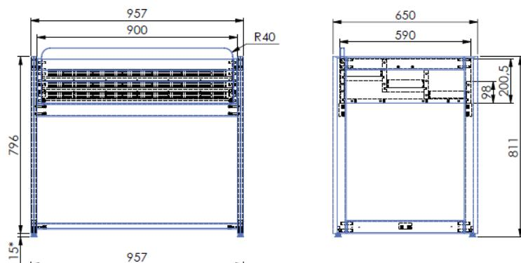
Dimensions : Longueur 956mm hauteur 848mm profondeur 650mm
