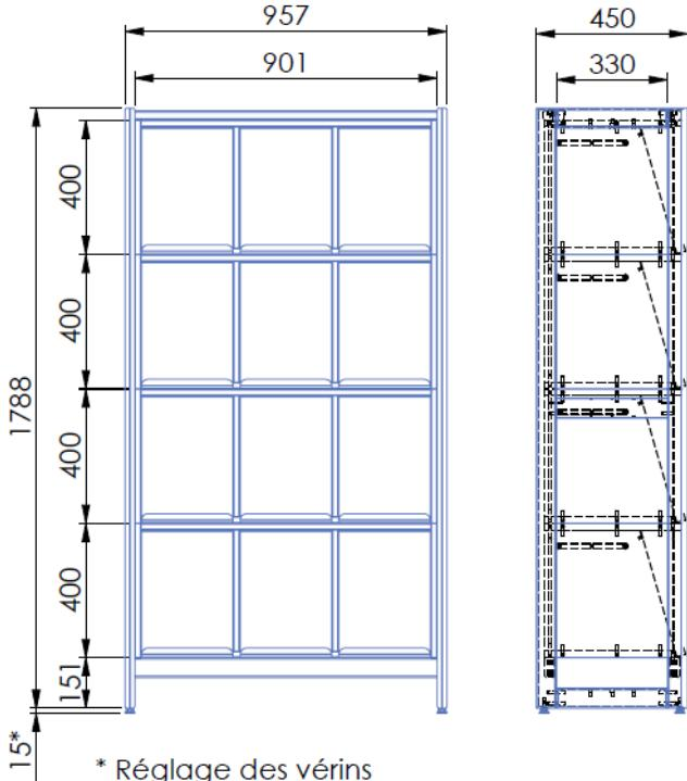
Dimensions : Longueur 956mm hauteur 1788mm profondeur 450mm
