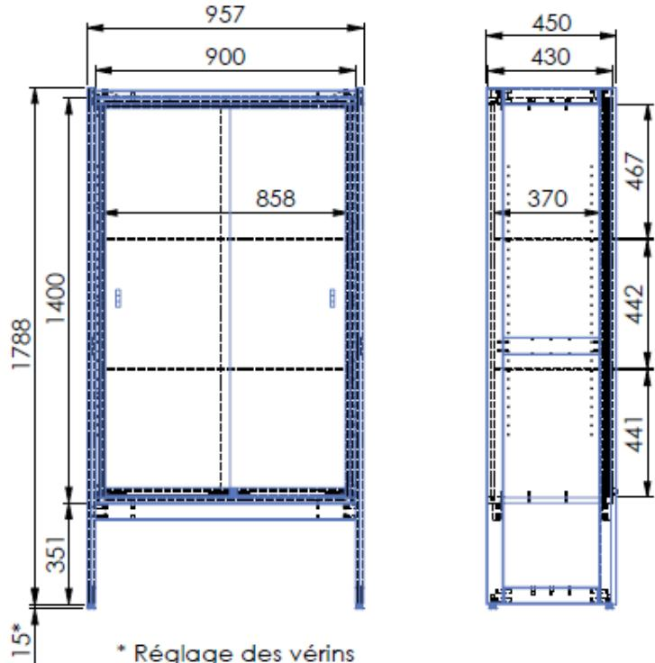
Dimensions : Longueur 956mm hauteur 1788mm profondeur 450mm
