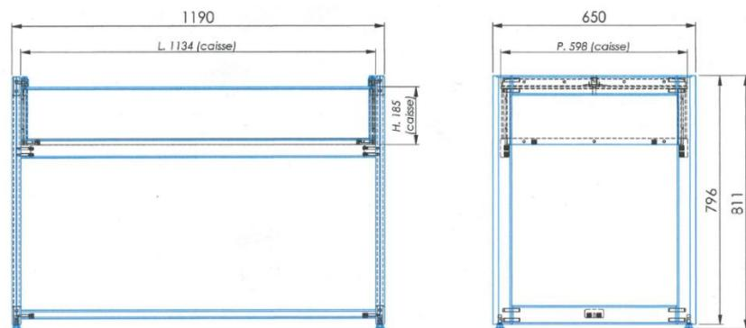
Dimensions : Longueur 1190mm hauteur 811mm profondeur 650mm
