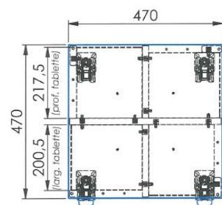
Dimension : largeur 470 hauteur 1061 profondeur 470mm
