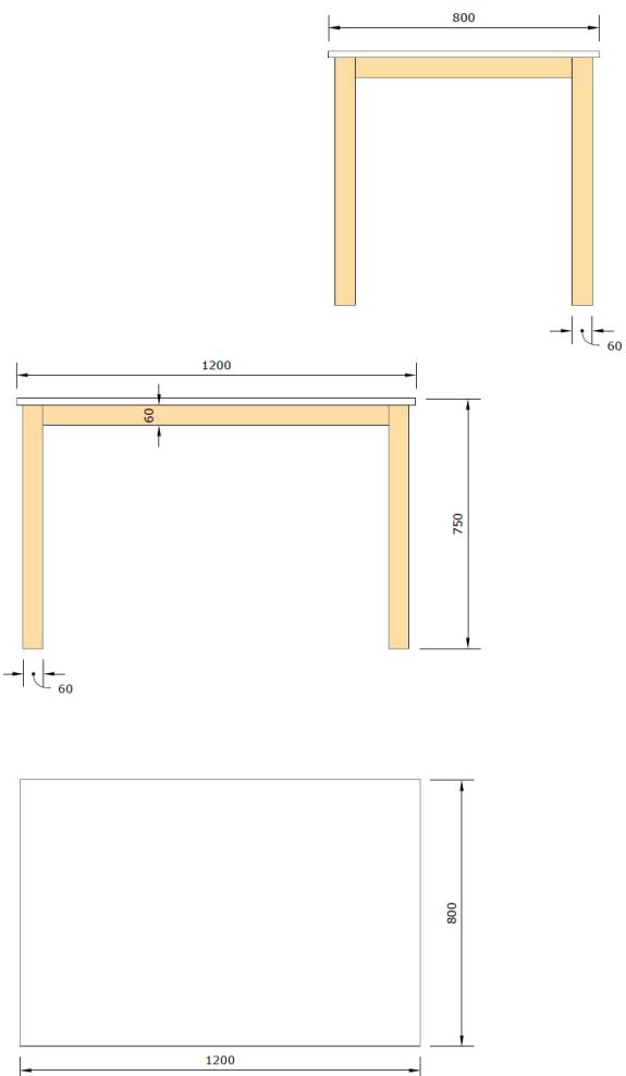
Dimensions : largeur 1200 hauteur 750 profondeur 800mm.
