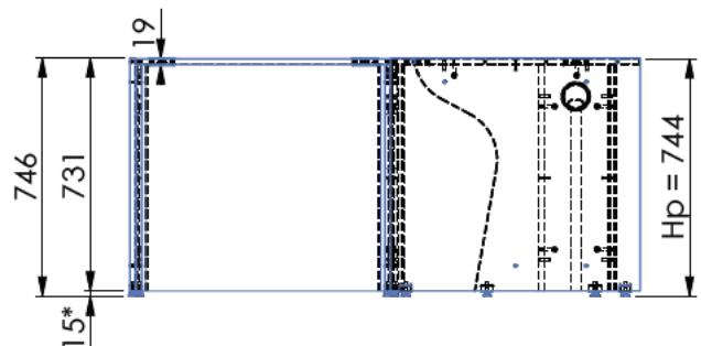
Le plateau est fabriqué en panneau de particules surfacé mélaminé épaisseur 19mm . Les chants en contact direct avec les utilisateurs sont en ABS 2mm .
