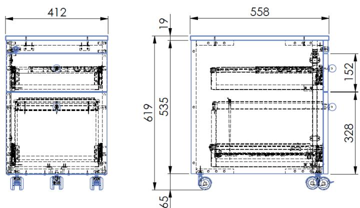
Le caisson mobile 2 tiroirs est fabriqué en panneaux de particules surfacé mélaminé épaisseur 19mm.
