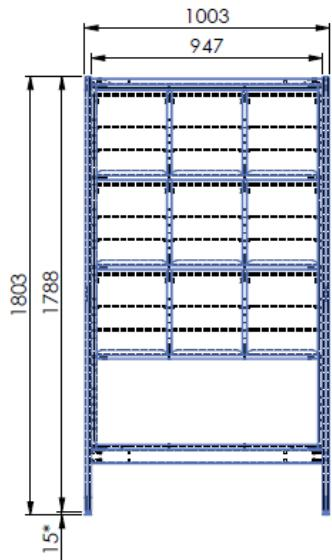
Dimensions : Longueur 1003mm hauteur 1803mm profondeur 450mm
