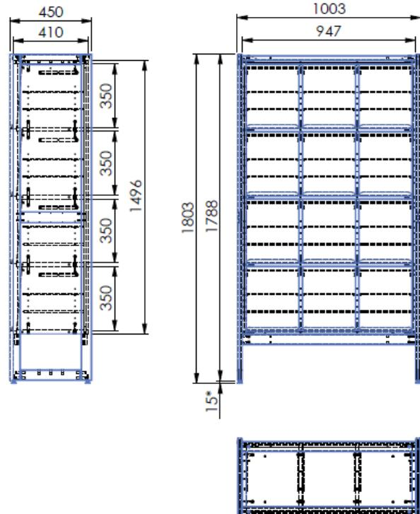
Dimensions : Longueur 1003mm hauteur 1803mm profondeur 450mm
