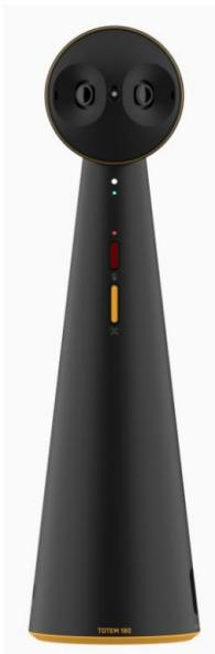
Capturez l'ensemble de la pièce grâce à deux caméras de 4 MP qui offrent une vue à 180° parfaitement assemblée, sans distorsion spatiale.
