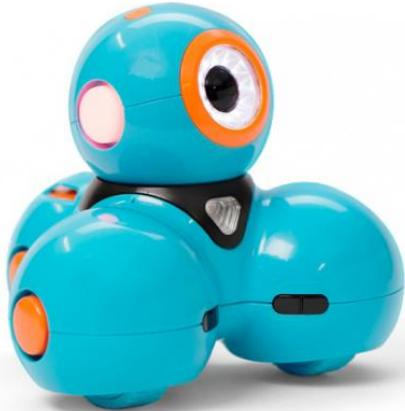
Dash est un petit robot qui peut être programmé via une tablette ou un smartphone pour jouer du xylophone, taper dans un ballon, transmettre des messages, ou encore pousser des briques.
