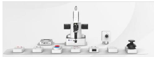
Kit de capteurs pour le robot Magician Lite
