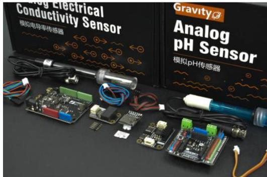
**KnowFlow est conçu pour les environnementalistes qui souhaitent surveiller la qualité de l'eau et obtenir des données en temps réel. Il permet de surveiller 2 paramètres avec un kit de base : pH et conductivités électroniques . Le kit est basé sur Arduino , facile à changer et à ajouter plus de capteurs et de modules . Actuellement, il stocke les données sur une carte micro-SD , les données peuvent également être visualisées sur votre smartphone via la communication Bluetooth .**
