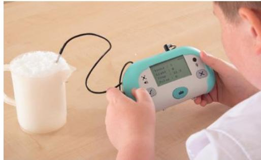
**Dispositif d'enregistrement de données facile à utiliser avec capteurs de température, de lumière et de son intégrés et un compteur d'impulsions.**
