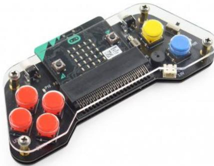
**Le gamepad Micro: bit est un gamepad d'extension basé sur micro: bit. Il vous suffit de brancher le micro: bit, il se transformera en une télécommande sans fil en une console de jeux.**
