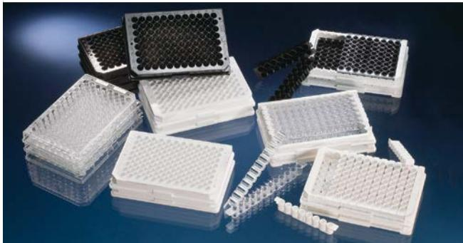
Pour travaux en fluorescence et luminescence. Stériles, avec couvercle. Fond plat. Microplaques noires : pour fluorescence et luminescence ; elles dispersent la lumière et réduisent le bruit de fond. Microplaques blanches : pour fluorescence et luminescence ; elles maximisent le signal et éliminent les problèmes d'autofluorescence et de luminescence.
