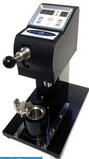
Broyage de cellules par agitation d'un mélange échantillon-billes de verre à 2 °C.
