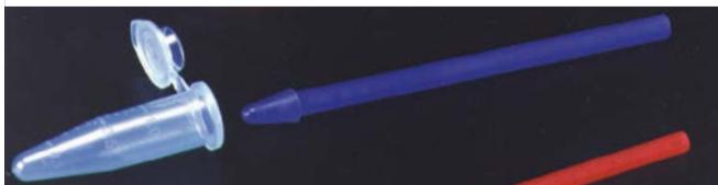
Pistons en polypropylène pour la remise en suspension de précipités protéiques et nucléiques, l'homogénéisation des cellules.
