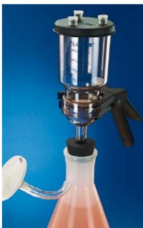
Pour filtration de l'air et des gaz (fermenteur de paillasse, incubateur à CO<sub>2</sub>, protection des pompes, filtration stérile de l'air).
