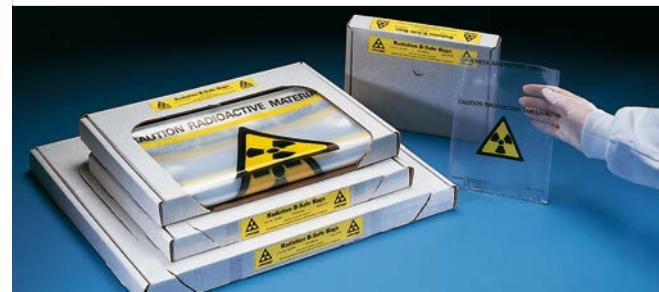
Sacs à déchets en polyéthylène marqués du pictogramme "Radioactivité" et de l'inscription "Attention matériel radioactif". Destinés aux déchets radioactifs. Il est recommandé de les utiliser dans un conteneur en acrylique protégeant du rayonnement bêta. Epaisseur : 500 gauge.
