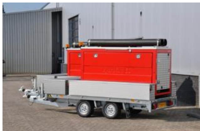
HydroSub 60 sur remorque grand plateau, avec compartiment de rangement, PTAC >2t
