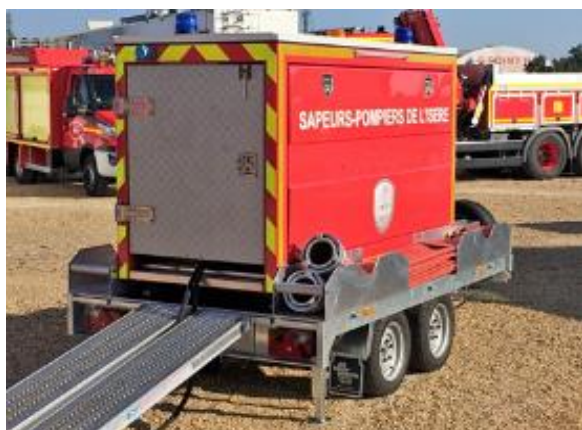
HydroSub 60 sur remorque petit plateau, avec rampes
