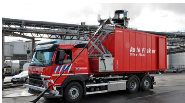
Berce HLC6500 avec système de relevage automatique HRU300 Auto-Flaker
