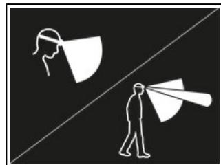
Le faisceau large et homogène offre une vision confortable pour les travaux à portée de main et le faisceau mixte permet de se déplacer facilement.
