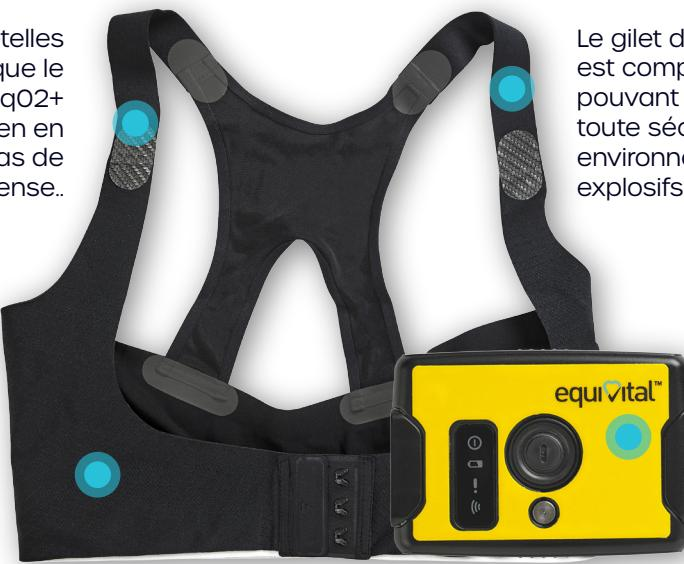
Le gilet du EX LifeMonitor est composée de matériaux pouvant être utilisés en toute sécurité dans des environnements hautement explosifs.
