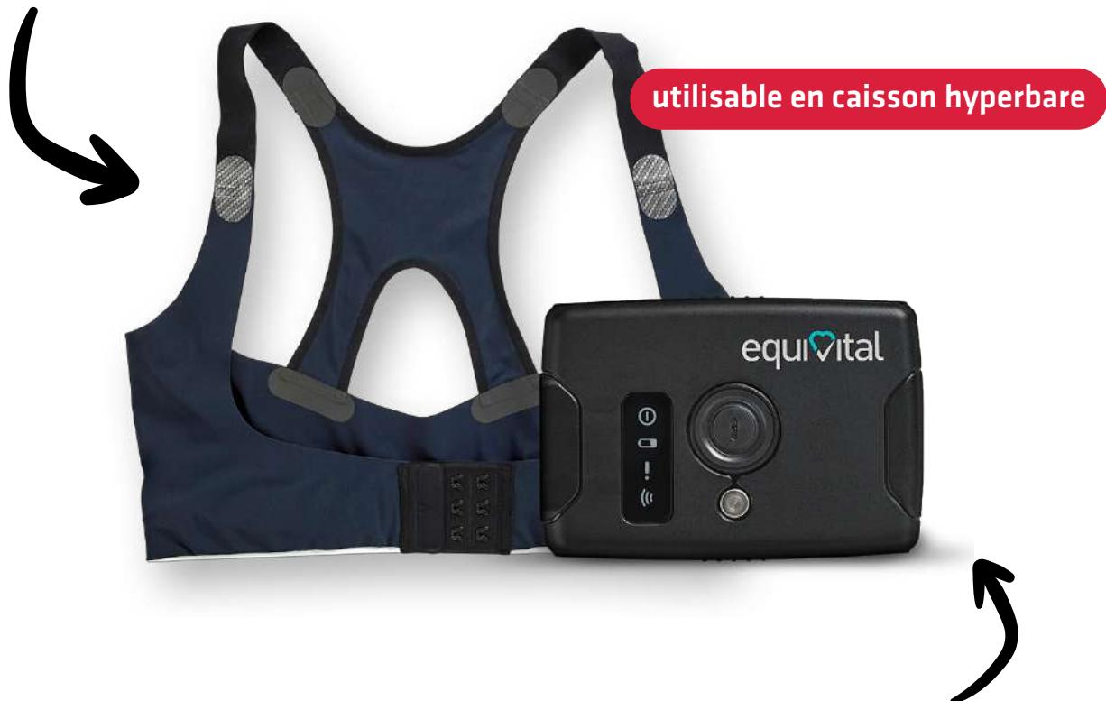
Les données sont collectées sur le SEM (Sensor Electronic Monitor). Ce petit module électronique s'intègre naturellement dans le gilet, sans compromis sur le confort. Il est composé d'un thermomètre infrarouge et d'un accéléromètre trois axes.
