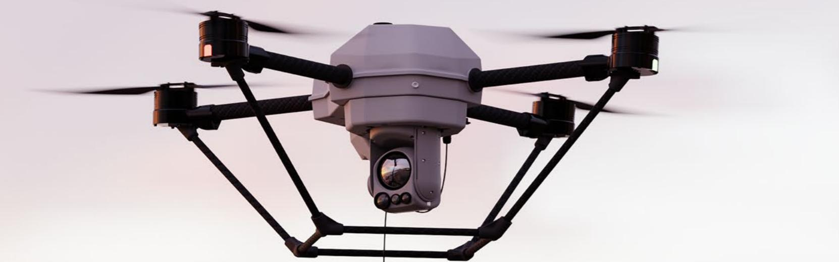
Le KHRONOS dronebox filaire est un drone quadrirotor de conception et de fabrication entièrement canadienne. Il est conçu pour être facile à utiliser et à déployer.
