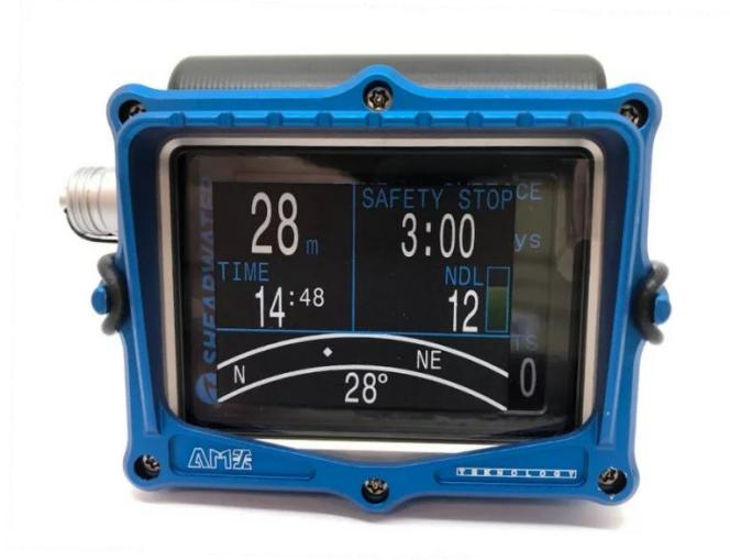
**Protector PETREL génération 2 et Titane a été développé pour améliorer la protection de votre ordinateur de plongée Shearwater. Ce nouveau design ne nécessite aucun démontage des vis du hublot. Il vient simplement coiffer le boitier sur presque 10mm. La protection latérale est améliorée et la tenue en position est parfaite. L'ensemble est maintenu par un bungee pour la sécurité. Réalisé en Aluminium T 6082 anodisé.**
