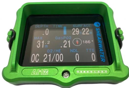
**Le système de protection de l'ordinateur PERDIX est réalisé en aluminium taillé masse et anodisé, il est conçu pour coiffer le boitier d'origine par emboîtement sur 8 mm de manière à protéger le dessus mais également les côtés du PERDIX. L'ajustement serré lui assure un bon maintien, le Protector est sécurisé par 2 joints toriques afin d'éviter toute perte. Ce système ne nécessite aucun outil pour sa mise en œuvre et peut être retiré très rapidement pour le nettoyage.**
