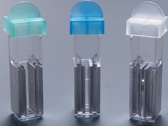
Cuvettes stériles pour électroporation compatibles avec toutes marques d'électroporateur.
