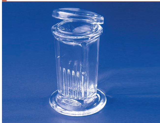
Boîtes en verre sodocalcique avec couvercle, de type Coplin. Capacité : 5 lames 76 x 26 mm ou 10 lames dos à dos.
