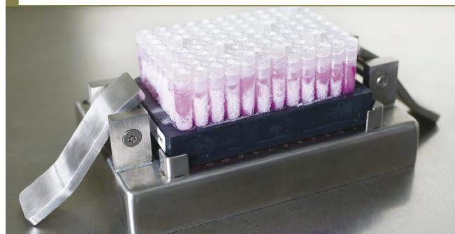
Outil de récupération des cryotubes Bank-It et CryoBank. Permet de sélectionner les tubes à prélever dans un rack complet.
