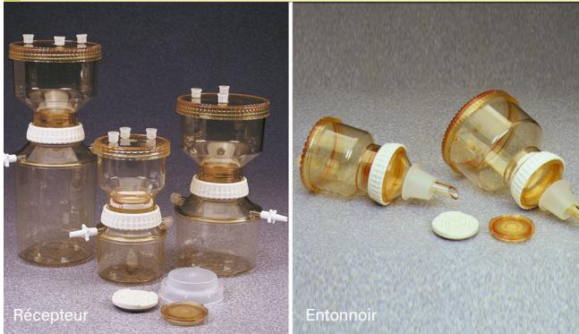
Ensemble comprenant un récipient supérieur et un récipient récepteur en polysulfone autoclavable et réutilisable.
