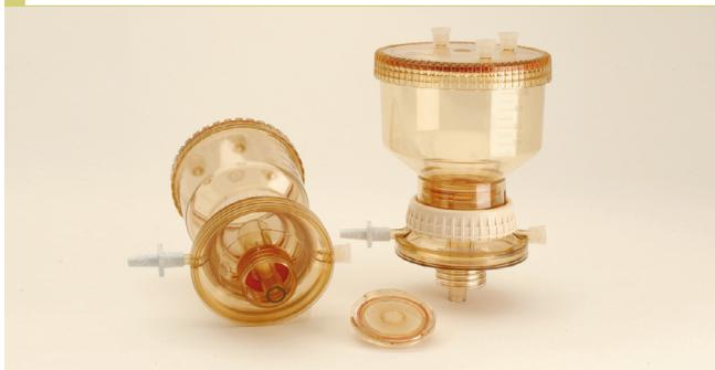
Support de membrane 47 mm en polysulfone autoclavable et réutilisable. Il se visse sur le col d'un flacon standard de laboratoire de type Schott, Duran, Pyrex de col 33 ou 45 mm.
