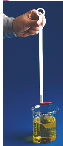
Tige rigide à extrémité magnétique pour le retrait des barreaux.
