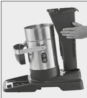
Positionner la **trémie d'évacuation en continu** dans le trou du support.
