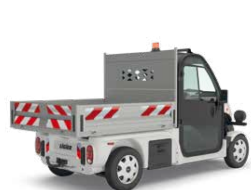
PLATEAU 3 RIDELLES FIXE OU BASCULANT avec vérin hydraulique
